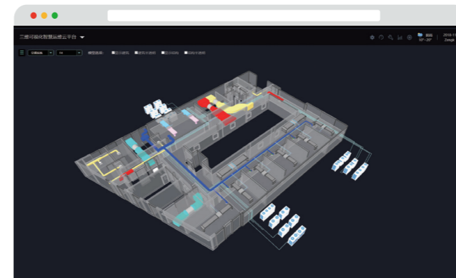
BIM 模型实时展示设备的位置、运行状态、连接关系
