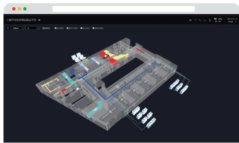
1. BIM 模型准确定位报警发生的设备、位置及影响区域
